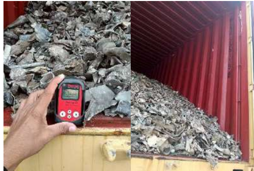
ภาพที่ 2.2-1 การตรวจเช็คสารกัมมันตรังสีในพื้นที่โครงการก่อนจัดเก็บในอาคาร
